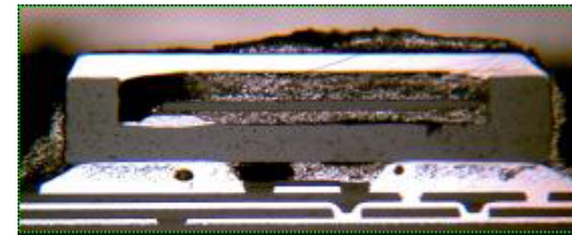
研磨を行い、振動板の側面出しを行う
